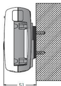
Standardmässig ist das Rechenwerk direkt auf dem Volumenmessteil montiert. Bei einer Temperatur > 30 °C wird für das Rechenwerk eine Wandmontage empfohlen. Wenn wegen beengter Einbauverhältnisse die Ablesbarkeit eingeschränkt ist, müssen Sie das Rechenwerk separat an einer ebenen Wand befestigen. - Dafür gibt es einen separaten Wandbeschlag.
